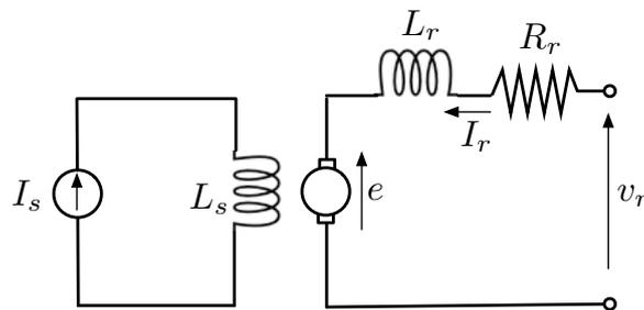
FIGURE 3.11 – Moteur DC commandé par le rotor
