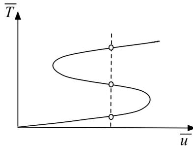
FIGURE 7.6 – Diagramme d'équilibre pour un réacteur chimique simple
