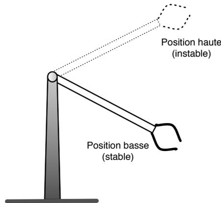
FIGURE 9.1 – Bras de robot dans un plan vertical
