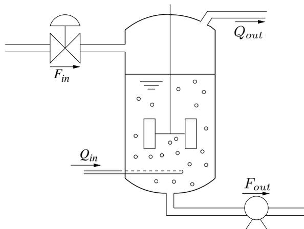
FIGURE 5.10 – Réacteur avec réactifs et produits gazeux
