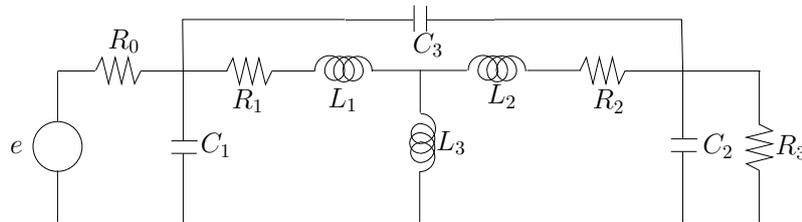
FIGURE 3.15 – Circuit équivalent d'un transformateur
