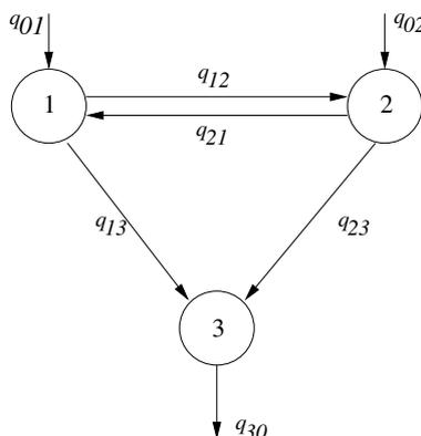
FIGURE 4.2 – Exemple de graphe d'un système à compartiments
