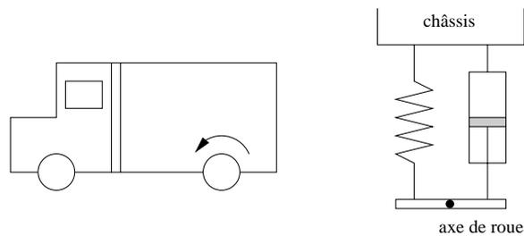
FIGURE 2.10 – Modélisation de la dynamique d'un camion
