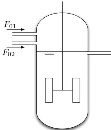
FIGURE 5.8 – Réacteur continu avec alimentations séparées
