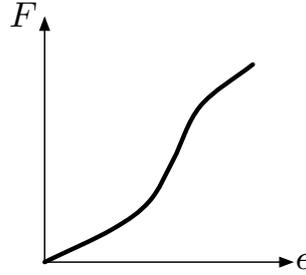
FIGURE 2.5 – Articulations élastiques : force de rappel en fonction de l'élongation
