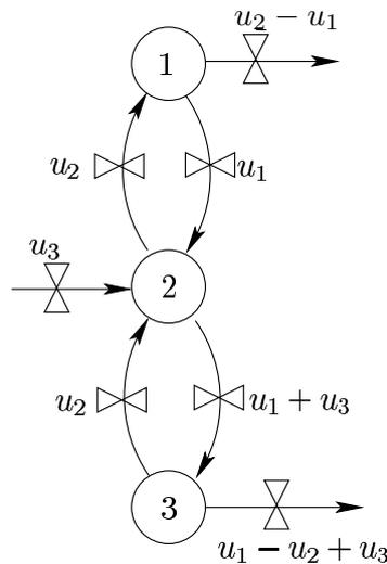
FIGURE 4.10 – Graphe associé au procédé de distillation
