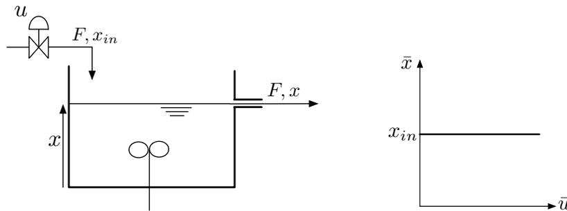
FIGURE 7.3 – (a) Cuve de mélange à volume constant. (b) Diagramme d'équilibres.
