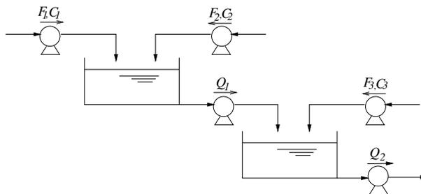
FIGURE 4.13 – Réseau de cuves de mélange
