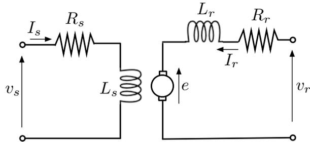
FIGURE 3.9 – Machine à courant continu
