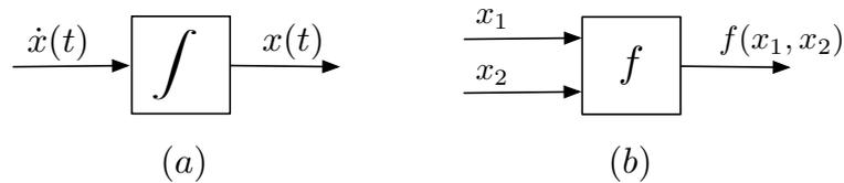
FIGURE 6.1 – Blocs fonctionnels : (a) intégrateur, (b) fonction
