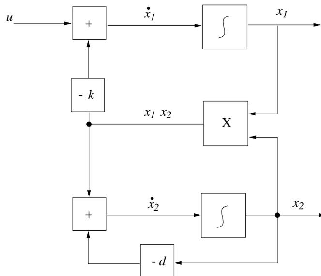
FIGURE 6.3 – Schéma fonctionnel du modèle de croissance d'algues
