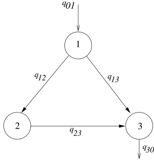
FIGURE 4.4 – Graphe associé à la cascade de réservoirs
