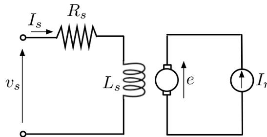
FIGURE 3.10 – Moteur DC commandé par le stator
