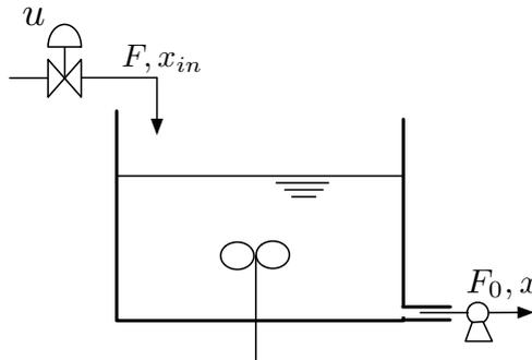
FIGURE 7.4 – Cuve de mélange à écoulement forcé
