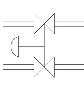
FIGURE 5.9 – Alimentations séparées avec vanne à quatre voies
