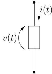
FIGURE 3.1 – Dipôle électrique
