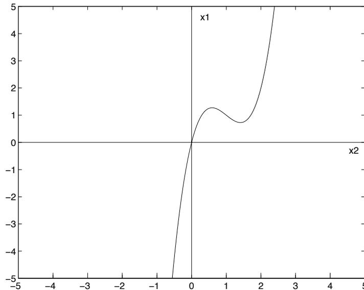
FIGURE 8.9 – Caractéristique courant-tension de la diode tunnel
