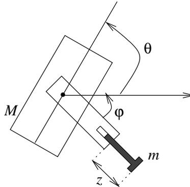
Les deux entrées de commande du système sont les vitesses d'orientation et d'élongation de la jambe.
