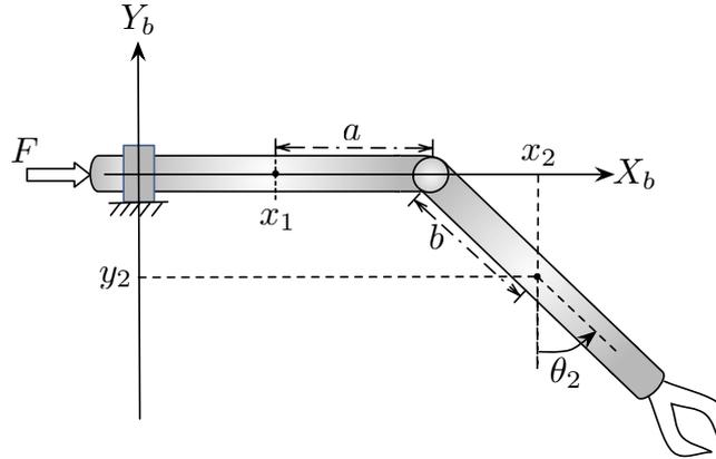
FIGURE 2.3 – Modélisation d'un robot manipulateur
