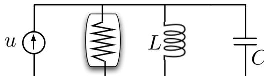
La caractéristique courant-tension  $i = g(v)$  de la résistance non-linéaire est une fonction monotone croissante telle que représentée sur la figure suivante :
