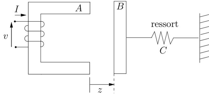
FIGURE 3.8 – Système électro-mécanique de positionnement
