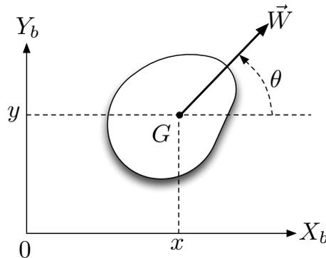
FIGURE 2.1 – Coordonnées d'un corps rigide dans le plan
