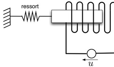
FIGURE 3.16 – Convertisseur électromécanique
