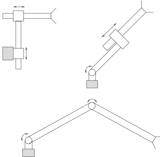
FIGURE 2.6 – Configurations de robots manipulateurs planaires
