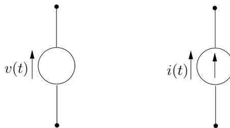
FIGURE 3.3 – Sources de tension et de courant
