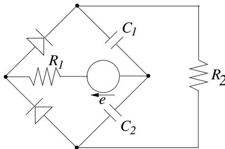
FIGURE 3.14 – Pont doubleur de tension
