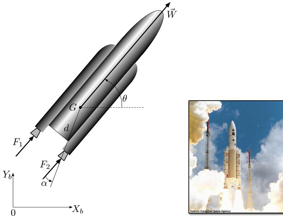
FIGURE 2.2 – Modélisation de la dynamique d'une fusée - Photo de la fusée Ariane au décollage (© ESA)
